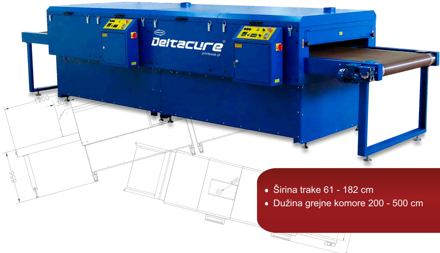
DELTACURE serija električnih tunela je napravljena za dugotrajnost i efikasnost. Dizajn grejnih komora u segmentima omogućava uštedu energije u zavisnosti od potreba određenog posla kao i kasniju mogućnost dogradnje. Dostupan je sa širinama transportne trake od 61 - 182 cm.
